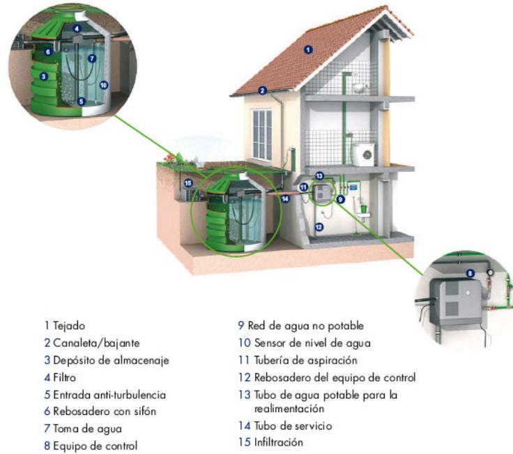
Figura 6. Figura1. Guía Técnica de aprovechamiento de aguas pluviales en edificios de Aqua España
