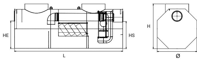
TN: Caudal (l/s) /  $Q_p$ : Caudal Punta / V: Volumen /  $\varnothing$ : Diámetro / L: Longitud / H: Altura / A: Ancho / HE: Cota de entrada / HS: Cota de salida / HC: Hidrocarburo
