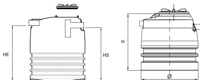
TN: Caudal (l/s) / Q<sub>p</sub>: Caudal Punta / V: Volumen / Ø: Diámetro / L: Longitud / H: Altura / A: Ancho / HE: Cota de entrada / HS: Cota de salida / HC: Hidrocarburo
