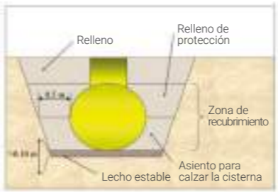
Figura 1: Esquema general de instalación.
