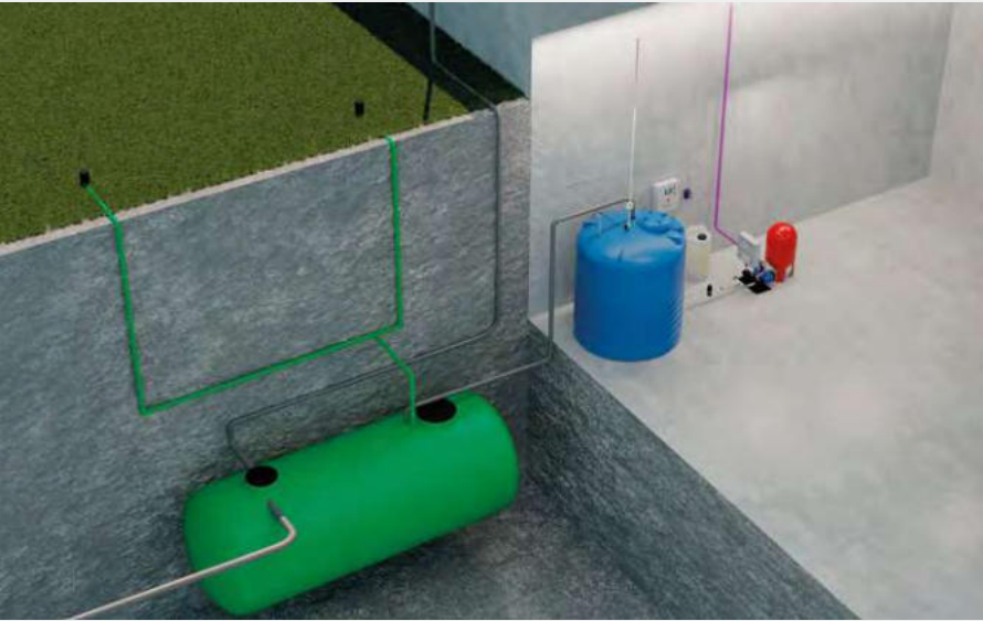
Instalación complea de aprovechamiento de aguas pluviales para riego de zonas ajardinadas y descarga de wc de una vivienda.
